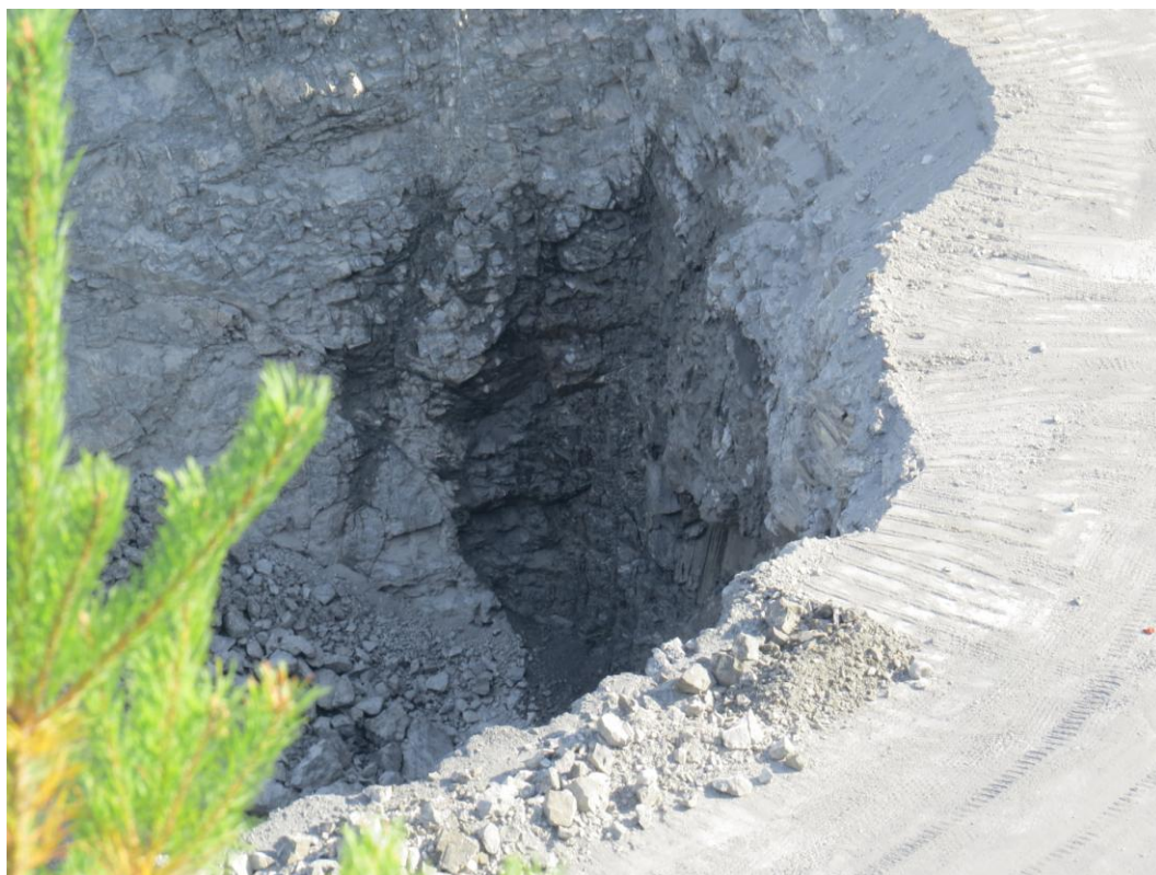
Obr. č. 4. Vlhnutí v jv. části stěny na na 4. etáži.
