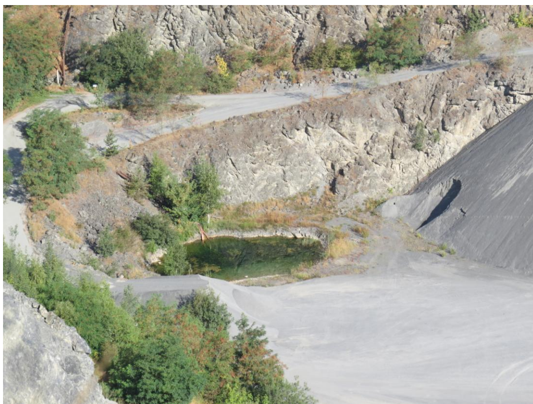
Obr. č. 2. Vodní jímka na 5. etáži.
